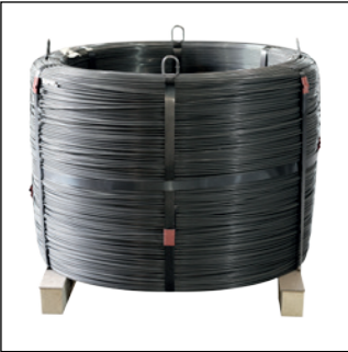
DIN 1400 1500-3000 kg Diametro interno 800 Diametro esterno varia in funzione al peso Altezza 750 mm Posato su travi in legno Diametro del filo: da 3,5 mm a 13 mm
