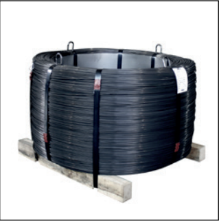
DIN 1400 1000-1500 kg Diametro interno 800 Altezza 550 Posato su travi in legno Diametro del filo: da 3,5 mm a 13 mm Anima interna in metallo
